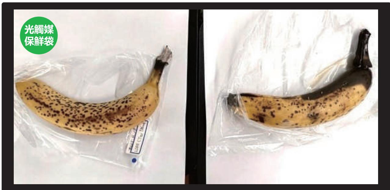
本次的光觸媒母粒，係採用本公司之羥基磷灰石包覆二氧化鈦經加工混練而成，其效果源自羥基磷灰石的吸附特性與二氧化鈦的殺菌作用。此為吸附腐敗過程中產生的乙烯，並藉由二氧化鈦進行分解之結果。
